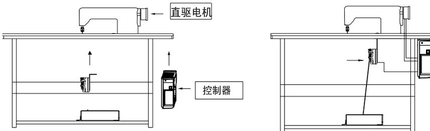
图 2-3 控制器安装示意图
