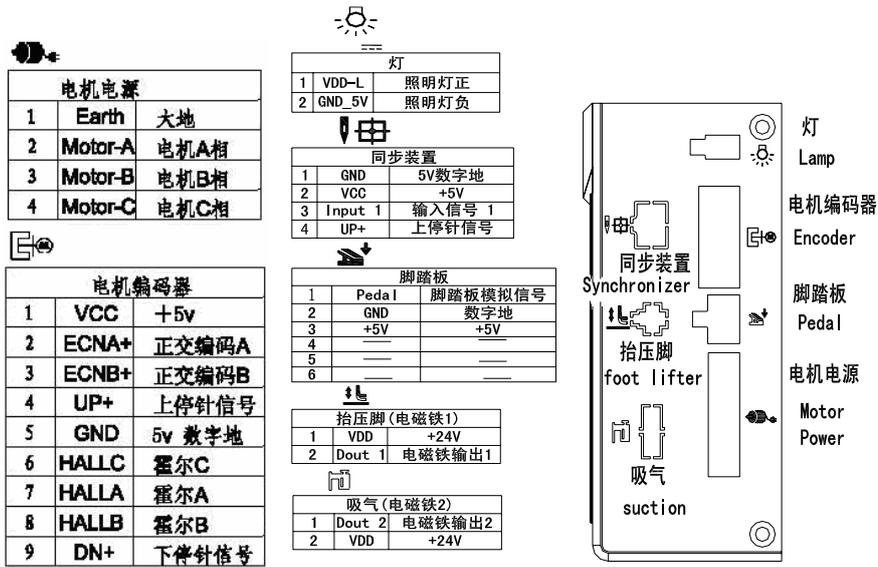
图 4-1 控制器对外接口示意图
